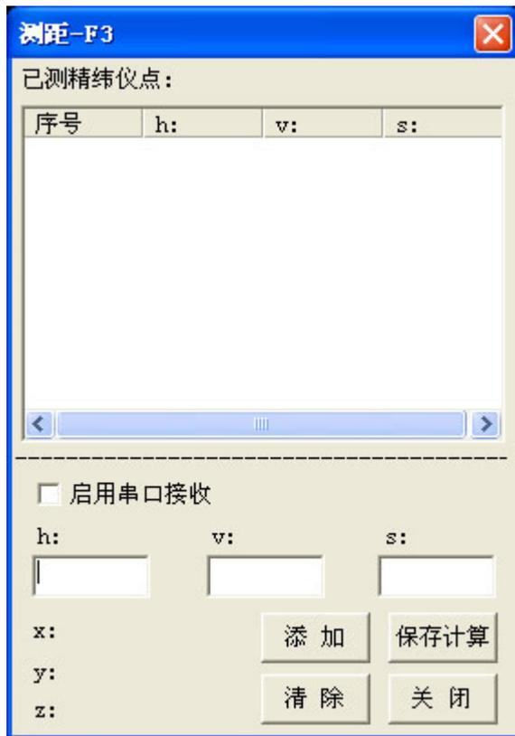
**第一步** 选取屏幕上的任意一点，测量这一点与全站仪之间的距离。方法如下：首先打开全站仪的激光点，全站仪的初始界面下按[DISP]键 — [F1]键（瞄准）— 转动全站仪使激光点射到屏幕上任意一点 — 再按[F1]键（测距），测距结束后，全站仪上会显示 VZ, HR, SD 三个读数，分别代表这时激光点所对应的垂直方向角、水平方向角、以及激光点与全站仪之间的距离。
